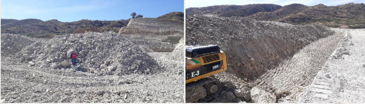
También se realizó acopio de materia prima siguiendo dos metodologías: al inicio reduciendo de tamaño de forma simultánea a la extracción y acopio, y luego posteriormente a un análisis de costos y rendimientos, se tomó la decisión de realizar acopio en fracción gruesa únicamente con excavadoras y que se encargara el tractor de reducir.
