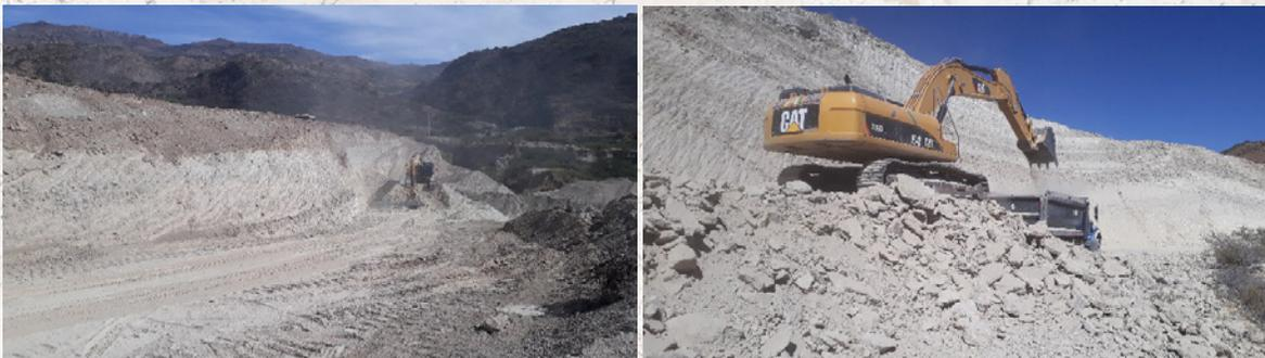
Se realizó acopio de materia prima en los frentes 1 y 2 sin hacer molienda o reducción de tamaño, debido a que no se tenía certeza de la granulometría de despacho.
