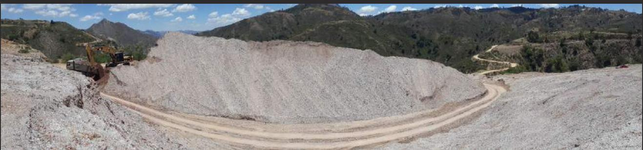
La Cantera La Zapatera provee de lutita a Planta Cal Orcko y debido a las características físicas de esta roca, las labores mineras deben ser planificadas minuciosamente para poder otorgar estabilidad a los taludes y bancos de explotación.
